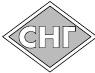
Рисунок А.27.1 - Образец опознавательного знака для ТС категорий М<sub>2</sub> и М<sub>3</sub>, использующих в качестве топлива СНГ или КПП
