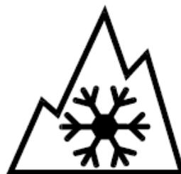
Рисунок А.10.2 - Маркировка, наносимая на зимнюю шину
